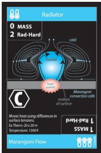
**Поточный радиатор Марангони (Marangoni Flow Radiator)** — в условиях невесомости градиент поверхностного натяжения может создать тепловой насос без движущихся частей или управлять процессами микроочистки. Это явление, называемое эффектом Марангони, перемещает жидкость из области с высоким поверхностным натяжением в область с низким поверхностным натяжением. - *Г. Гарри Стайн, Третья промышленная революция, 1979.*
