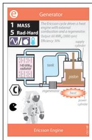
**Генератор Эрикссона (Ericsson Engine Generator)** — термодинамический цикл Эрикссона подобен циклу Стирлинга в том, что оба они эффективно вырабатывают электричество, используя внешнее горение с регенераторами. Оба цикла могут работать от солнечного или ядерного источника тепла. В игровом дизайне используется последний, генерирующий 60 МВт при 3000 об/мин и КПД 30%.
