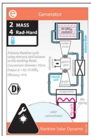
**Солнечный динамический генератор Ренкина (Rankine Solar Dynamic Generator)** — в этой версии цикла тепловой машины Ренкина используются двойные рабочие жидкости: ртуть (высокая температура) и толуол (промежуточная температура). Солнечный концентратор нагревает ртуть, которая передает свою энергию толуолу в испарителе. Общий КПД (от солнечной энергии к электроэнергии переменного тока) составляет 41%.
